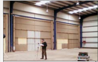
Ensayo de Tr en nave industrial
