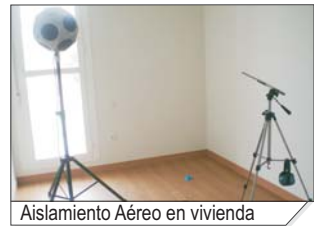
Aislamiento Aéreo en vivienda
